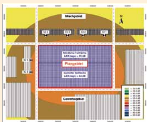
▲ Abbildung: Schematisches Beispiel einer Geräuschkontingentierung
